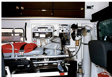
Foto 24/25. Het interieur van de Opel Senator met een Ferno-Washington brancardonderstel en (links tegen de wand) een schepbrancard, een Medumat-beademingsautomaat van Weinmann, een beademingsballon met gezichtsmasker aan de zuurstoffles en een M/D3-monitor/defibrillator van Datascope. Via de achterklep zijn rechts de hartmassageplank en de beugels voor een tweede brancard zichtbaar.
