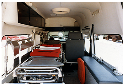
Foto 24/25. Het interieur van de Opel Senator met een Ferno-Washington brancardonderstel en (links tegen de wand) een schepbrancard, een Medumat-beademingsautomaat van Weinmann, een beademingsballon met gezichtsmasker aan de zuurstoffles en een M/D3-monitor/defibrillator van Datascope. Via de achterklep zijn rechts de hartmassageplank en de beugels voor een tweede brancard zichtbaar.
