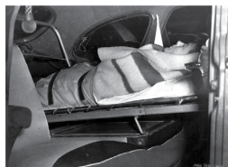
Foto 19. Het interieur van een overeenkomstige Chrysler Windsor uit 1947 van het Witte Kruis uit Den Haag als van Jan Rooney uit Hoek van Holland met een op een uitneembaar brancardonderstel ingebrachte brancard.
